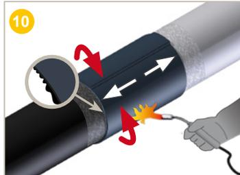
Continuer à **chauffer** en partant du centre vers chaque extrémité jusqu'au rétreint complet. Terminer par des mouvements horizontaux sur toute la surface de la bande.
